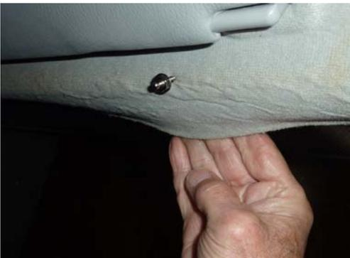
Ist der Fahrzeughimmel aus Pappe (Fiat Typ 250/290) muss auf der Rückseite die mitgelieferte Blechmutter hinterlegt werden. Über der Frontscheibe kann man hinter den Fahrzeughimmel fassen und das Loxx Unterteil somit mit Hilfe der Blechmutter festschrauben.
