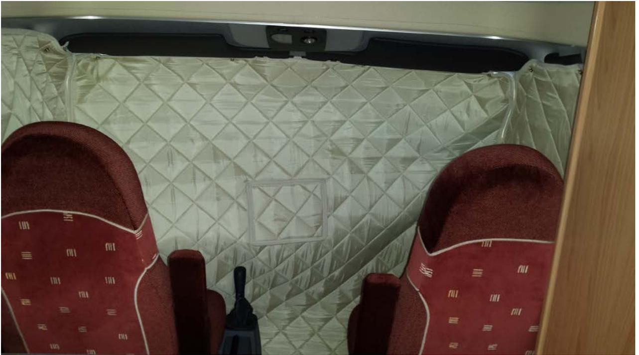
Die im Vorhang eingearbeiteten Loxx Oberteile vom ISOTHERM – Vorhang XXL auf den Fahrzeughimmel übertragen. Dazu das Loxx Unterteil in das Oberteil einstecken und als Körner benutzen. Anschließend abbohren. (3 mm Bohrer)
