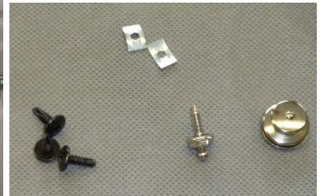
Ist der Fahrzeughimmel aus Pappe (Fiat Typ 250/290) muss auf der Rückseite die mitgelieferte Blechmutter hinterlegt werden. Über der Frontscheibe kann man hinter den Fahrzeughimmel fassen und das Loxx Unterteil somit mit Hilfe der Blechmutter festschrauben. Die Montage der Loxx Unterteile am Fahrzeughimmel und über den Türen kann von Fahrzeug zu Fahrzeug unterschiedlich sein.
