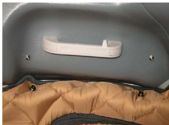
Bei Fahrzeugen mit Kunststoffhimmel mittels 3 mm Bohrer vorbohren und die Loxx Unterteile einschrauben und ISOTHERM – Vorhang XXL befestigen
