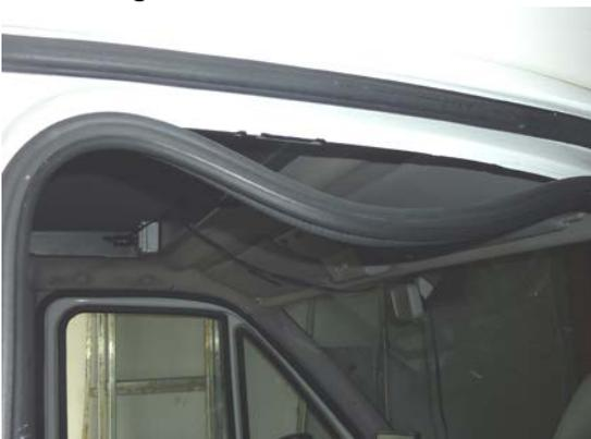
Bei der Befestigung über den Türen muss der Türdichtungsgummi abgezogen werden, sodass man auch hier hinter den Fahrzeughimmel greifen kann um das Loxx Unterteil mit der Blechmutter festzuschrauben.
