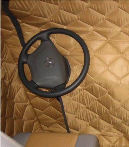
ISOTHERM – Vorhang XXL im Fahrerhaus ausbreiten. Reißverschluss am Lenkradausschnitt öffnen Lenkrad durchführen und Reißverschluss wieder schließen.
