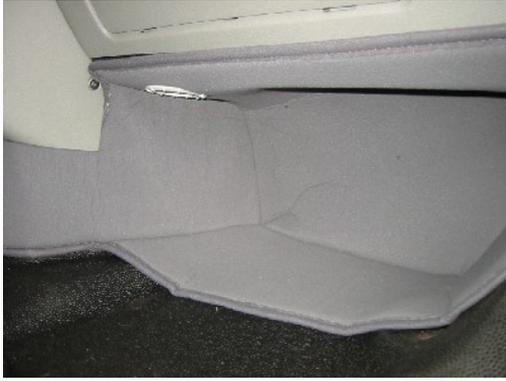
Fußraumisolierung auf Beifahrerseite einführen und im Fußraum ausbreiten. Am Klett befestigen. Bei richtiger Montage positioniert der linke Luftausströmer direkt vor dem Heizungsaustritt, keine direkte Verbindung notwendig.
