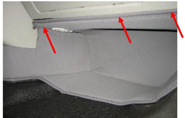
Fußraumisolierung mittels der mitgelieferten **6 Schrauben** zusätzlich am Armaturenbrett anschrauben.
