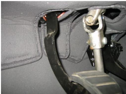
Die Klettverbindung auf der Isolierung öffnen und die Fußraumisolierung um die Lenksäule und Pedale führen, im Fußraum ausbreiten, hinter den Gashebelblock schieben und die Klettverbindung wieder schließen. Bei richtiger Montage positioniert sich der Luftausströmer direkt vor dem Heizungsausstritt, keine direkte Verbindung notwendig.
