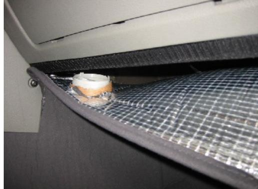
Klebestelle am unteren Rand der Armaturentafel ca. 2 cm breit mit Aceton oder ähnlichem reinigen, bei kalter Witterung Klebestelle und Klettband mit Fön gut anwärmen und anpressen.
