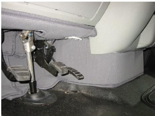
Die Fußraumisolierung auf Fahrerseite an den angeklebten Klett hängen.
