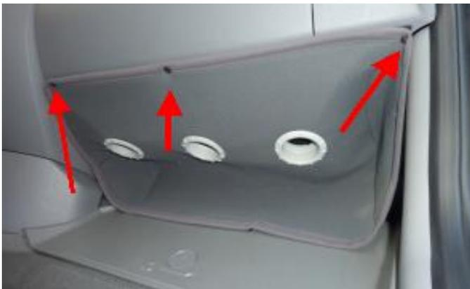
Fahrer- und Beifahrerseite der Matte am Klett befestigen, im Fußraum ausbreiten und im unteren Teil auf dem Bodenvlieszuschnitt oder mit Klett befestigen
