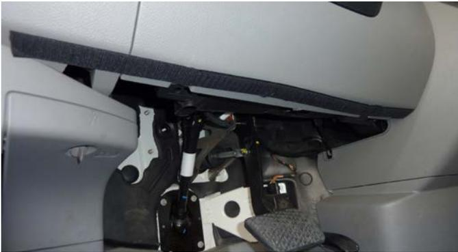
Klebestelle auf der Unterkante des Armaturenbrettes mit Aceton oder ähnlichem gut reinigen, bei kalter Witterung Klebestelle und Klettband mit Fön gut anwärmen
