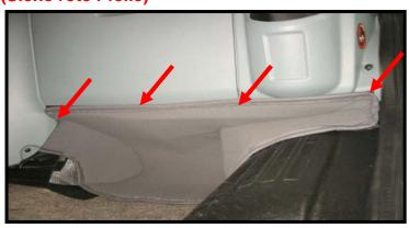
Fußraumisolierung auf der Beifahrerseite einführen und im Fußraum ausbreiten. Am Klett befestigen.
