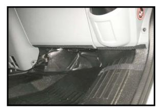
Klebestelle an der Unterkante des Armaturenbretts ca. 2 cm breit mit Aceton oder ähnlichem reinigen, bei kalter Witterung Klebestelle und Klettband mit Fön gut anwärmen und anpressen.
