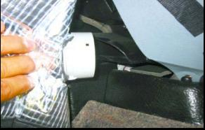
Die Fußraumisolierung auf der Fahrerseite über die Pedale führen und im Fußraum ausbreiten. Am Klett befestigen. Bei richtiger Montage positioniert sich der Luftausströmer direkt vor dem Heizungsaustritt, keine direkte Verbindung notwendig.
