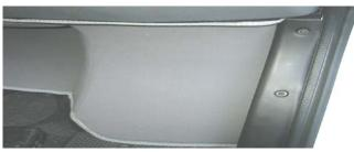
5.) Die Seitenteile werden links und rechts unter den Radlaufleisten (3 Schrauben) befestigt. Bei integrierten Modellen wenn nötig ankleben.
