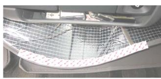
2.) Mittlerer Klettstreifen verbleibt auf der Matte und wird zum Schluss entsprechend der Mattenform angeklebt.
