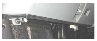
Klebestelle ca. 2 cm breit mit einem Schleifpapier anrauen, mit Aceton reinigen, bei kalter Witterung Klebestelle und Klettband mit Fön gut anwärmen und anpressen.
