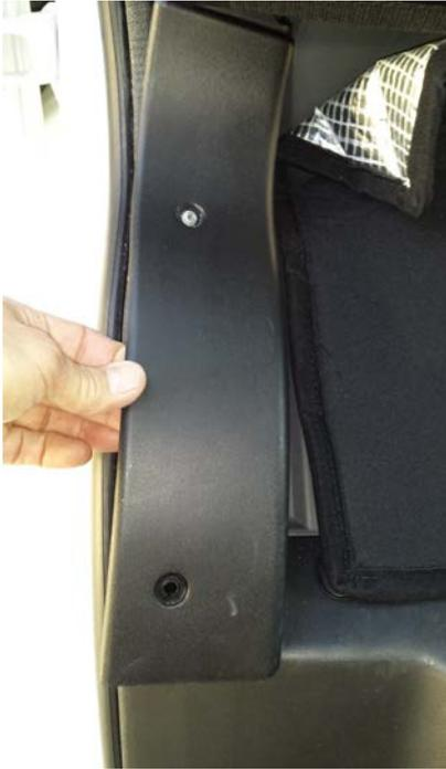
Die Seitenteile der Fußraumisolierung werden links und rechts unter den Radlaufleisten (3 Schrauben auf jeder Seite) befestigt.
