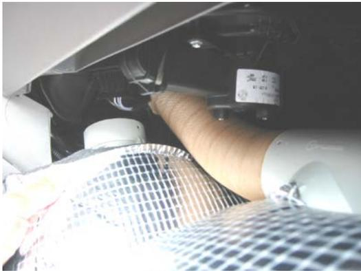
Auf der Beifahrerseite befinden sich 2 rechteckige Heizungsausstrittsöffnungen hintereinander. Auf die hintere Heizungsausstrittsöffnung kann das mitgelieferte Heizungsrohr ca. 1 cm aufgeschoben werden. Dabei verformt sich das Heizungsrohr im aufgeschobenen Bereich und passt sich somit an.
