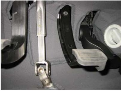
Die Verbindungslaschen an der Fahrerseite von Oberteil zu Unterteil öffnen. Fußraumisolierung Unterteil auf der Fahrerseite so weit wie möglich nach hinter ziehen, darauf achten das Lenkradausschnitt richtig sitzt. Die Verbindungslaschen die vom Oberteil kommen hinter die Lenksäule und zwischen den Pedalen entsprechend zuordnen. (bei Automatik ist es nur eine Verbindungslasche)
