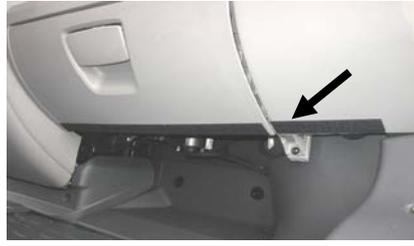
Klebestelle am Armaturenbrett ca.2 cm breit mit Aceton/Alkohol/Brennspiritus reinigen, Klettband auf Fahrer- und Beifahrerseite an der Unterkante des Armaturenbretts ankleben. Bei kalter Witterung Klebestelle und Klettband mit Fön etwas anwärmen und gut anpressen.
