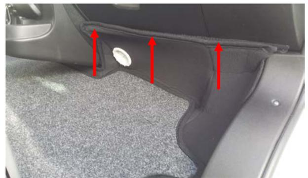
Fertig montierte Fußraumisolierung nochmals am Klett gut andrücken und mit den 6 Schrauben an den angezeigten Punkten mit dem Armaturenbrett verschrauben.
