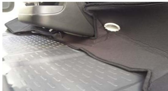
Bei richtiger Montage der Fußraumisolierung positionieren sich die Luftausströmer in der Fußraumisolierung direkt vor den Heizungsausstritten des Fahrzeuges, **es ist keine direkte Verbindung notwendig.**
