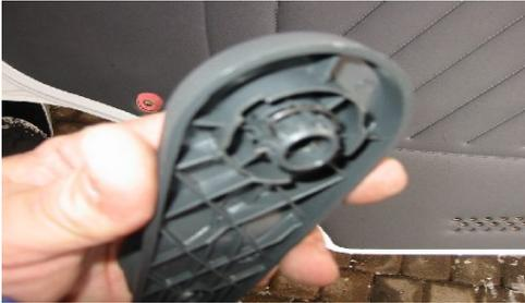
2.) Fensterkurbel abziehen, dazu muss der Sicherungsring hinter der Kurbel herausgezogen werden. Benutzen Sie einen schmalen Schraubenzieher oder einen schmalen Haken. Stecken Sie unbedingt den Sicherungsring wieder auf die demontierte Kurbel. Bei der Montage muss die Kurbel so nur aufgesteckt werden.
