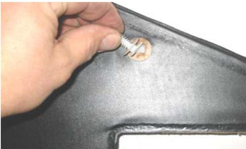
4.) Isolierung hinter der Original-verkleidung anbringen. Das aktuelle Material entspricht nicht mehr der Abbildung.
