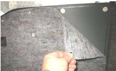
5.) Isolierung hinter der Originalverkleidung anbringen und beide Teile wieder in die Türe drücken. Die Montage aller Teile erfolgt in umgekehrter Reihenfolge. (Isoliermaterial nicht wie auf Bild)
