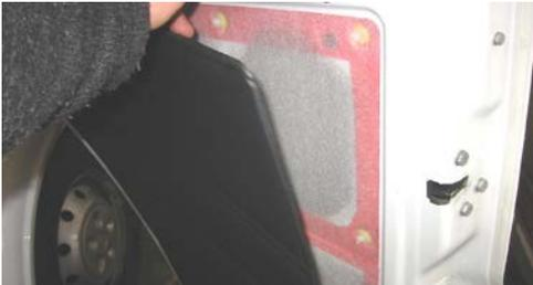
3.) Originalverkleidung abnehmen. Mit einem Schraubenzieher im Bereich der Befestigungsclips abheben. Die in der Türe verbleibenden Clips mit der Zange herausziehen.
