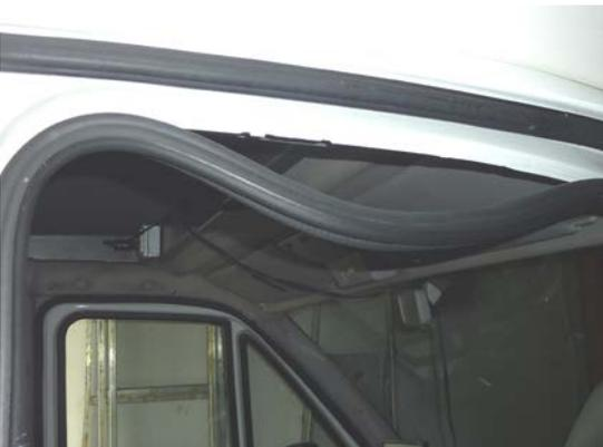
Bei der Befestigung über den Türen muss der Türdichtungsgummi abgezogen werden, sodass man auch hier hinter den Fahrzeughimmel greifen kann um das Tenaxunterteil mit Blechmutter festzuschrauben.
