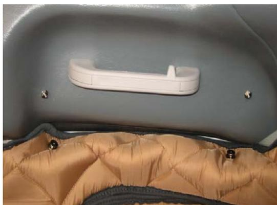
Bei Fahrzeugen mit Kunststoffhimmel mittels 3 mm Bohrer vorbohren und die Tenaxunterteile einschrauben und ISOTHERM – Vorhang XXL befestigen
