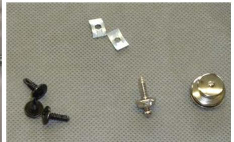
Ist der Fahrzeughimmel aus Pappe (Fiat) muss auf der Rückseite die mitgelieferte Blechmutter hinterlegt werden. Über der Frontscheibe kann man hinter den Fahrzeughimmel fassen und das Tenaxunterteil somit festschrauben.
