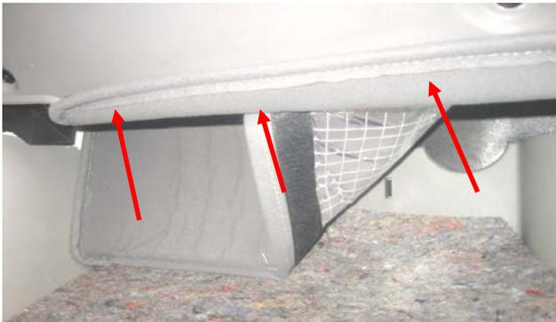
Seitliche Klettstreifen zusätzlich ankleben. Bei MB Sprinter ab Bj. 2000 Heizungsrohr auf Fahrerseite auf Austrittsrohr der Heizung aufschieben.
