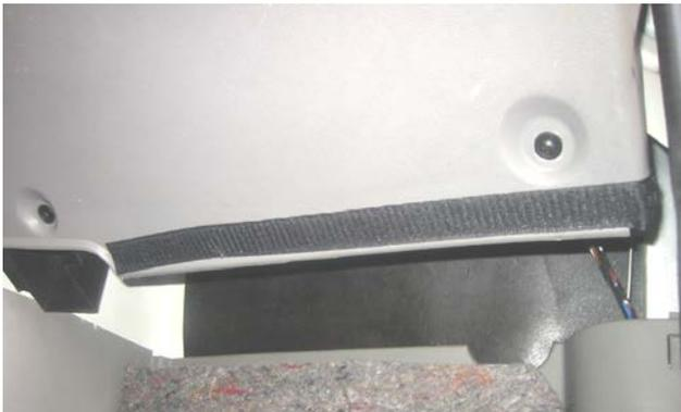
Klettband an Fahrer- und Beifahrerseite an der Unterkante des Armaturenbretts anbringen.
