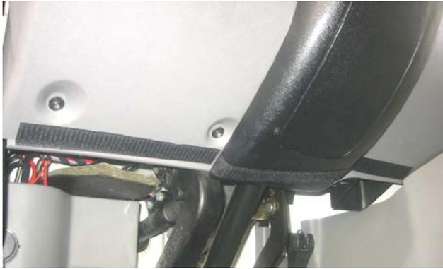
Klebestelle auf der Unterkante des Armaturenbrettes ca.2 cm breit mit Aceton oder ähnlichem reinigen, bei kalter Witterung Klebestelle und Klettband mit Fön gut anwärmen und anpressen.
