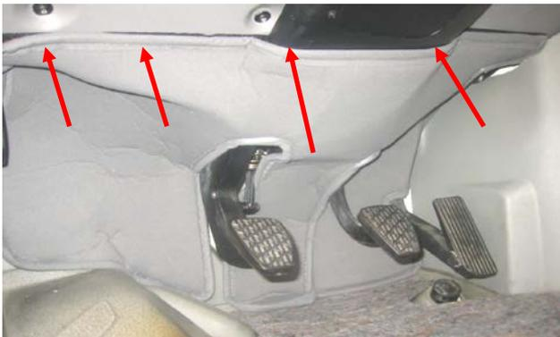
Fahrer- und Beifahrerseite am Klett befestigen, im Fußraum ausbreiten und im unteren Teil auf dem Bodenvlieszuschnitt oder mit Klett befestigen.
