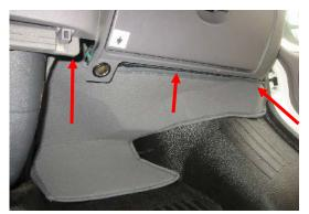
3.) Fußraumisolierung auf der Beifahrerseite am Klett befestigen, nach hinten in den Fußraum ausbreiten zusätzliche Klettstreifen ankleben und Fußraumisolierung zusätzlich mit Schrauben sichern. (Siehe rote Pfeile)
