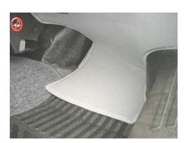
5.) Untere Teile mittels aufgenähtem Klett an dem Bodenvlieszuschnitt befestigen, oder mittels Klett ankleben.
