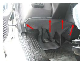
4.) Fußraumisolierung Oberteil auf der Fahrerseite am Klett befestigen, nach hinten in den Fußraum ausbreiten Pedalstreifen zuordnen mit dem Unterteil verbinden. Zusätzlich mit Schrauben sichern. (Siehe rote Pfeile)
