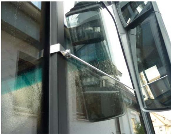
**Mittlere Gummizüge mit entsprechenden Haken an den Schiebefenstern einhängen.**
