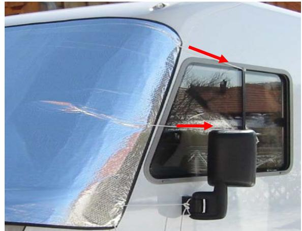
Oberer, durchgehender Gummizug der Frontmatte bei Spiegel unten an den Schiebefenstern mit entsprechenden Haken einhängen gegebenenfalls Gummi nachspannen, so das die Frontmatte oben gut und dicht anliegt.
