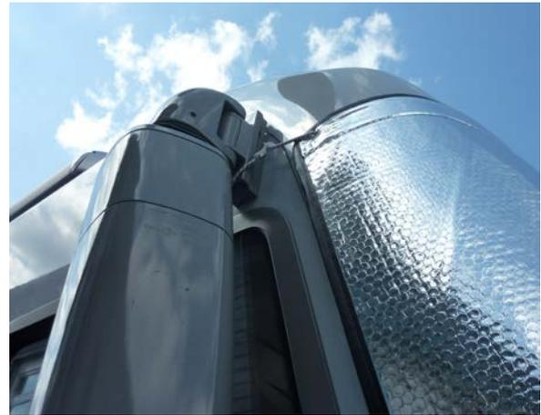
**Oberer, durchgehender Gummizug der Frontmatte bei Spiegel oben um den Rückspiegel führen und mit Kunststoffhaken einhängen.**
