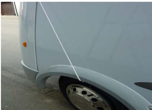
**Untere Gummizüge der Frontmatte am der Karosserie z.B. Radlauf befestigen.**
