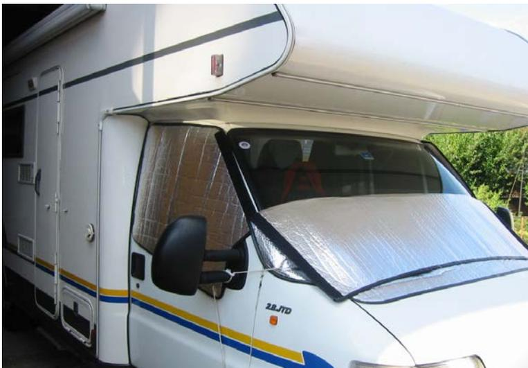
Frontmatte kann bei Bedarf von oben nach unten am Klett entlang abgeklappt werden.
