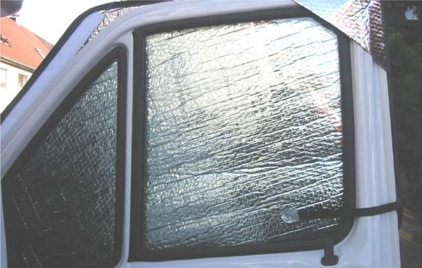
Seitenmatte von oben in die Türe einhängen. Gummi mit Sauger um den Türholmen herumführen und auf der Seitenscheibe von innen befestigen.
