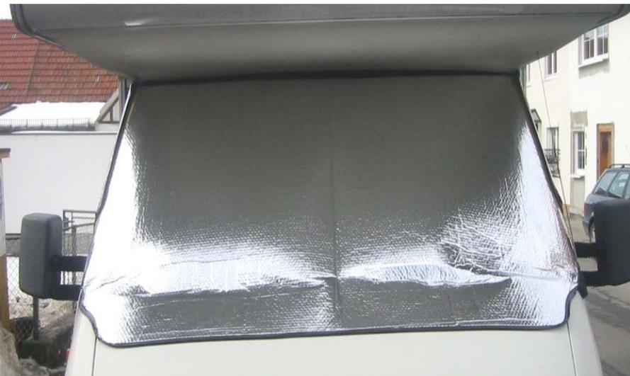
Frontmatte über die Scheibenwischer auf die Frontscheibe auflegen, und mit den Klettstreifen der Seitenteile verbinden. Expandergummi am Spiegel oder Radlauf befestigen.
