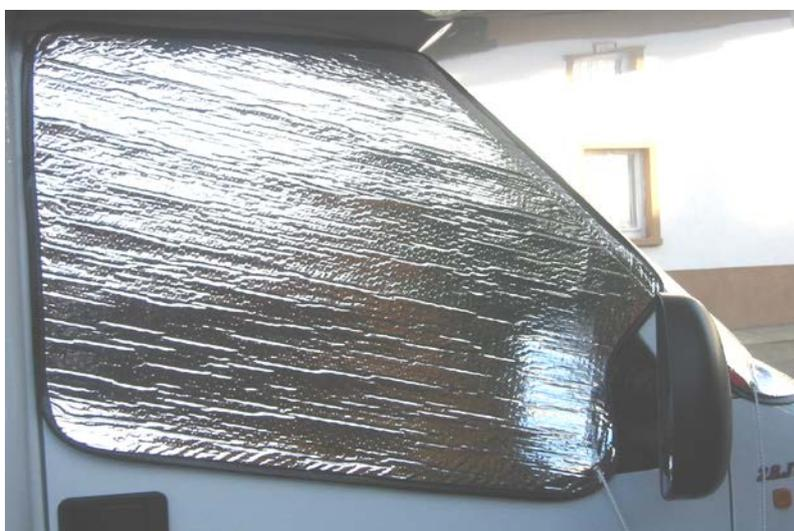
Expandergummi der Seitenteile am Spiegel oder Radlauf befestigen.
